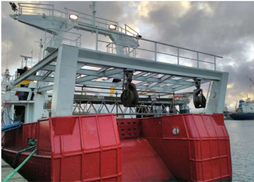
Plataforma en altura íntegramente de PRFV incluyendo barandilla de protección perimetral ergonómica, para aligerado de barco pesquero
