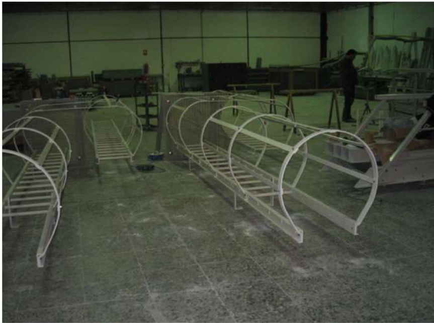
Escalera de seguridad con crinolina de protección dorsal
